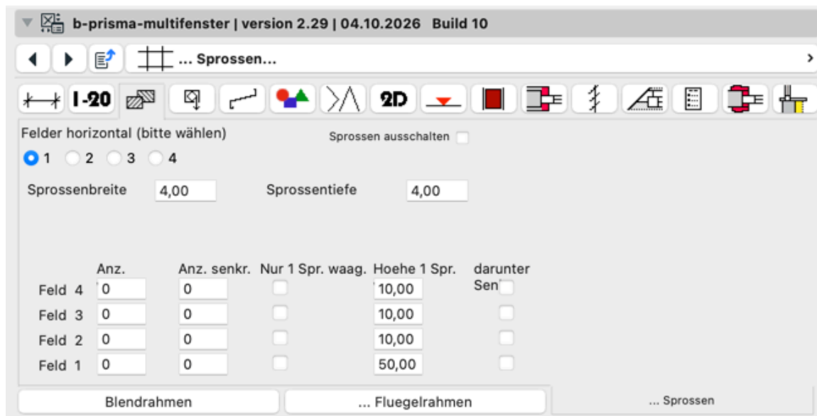
Abb. 06.1 · Unterseite „... Sprossen“: Breite und Tiefe für das ganze Element, Anzahl waagerecht und senkrecht je Feld, einzelne Sprosse mit Höhe.
