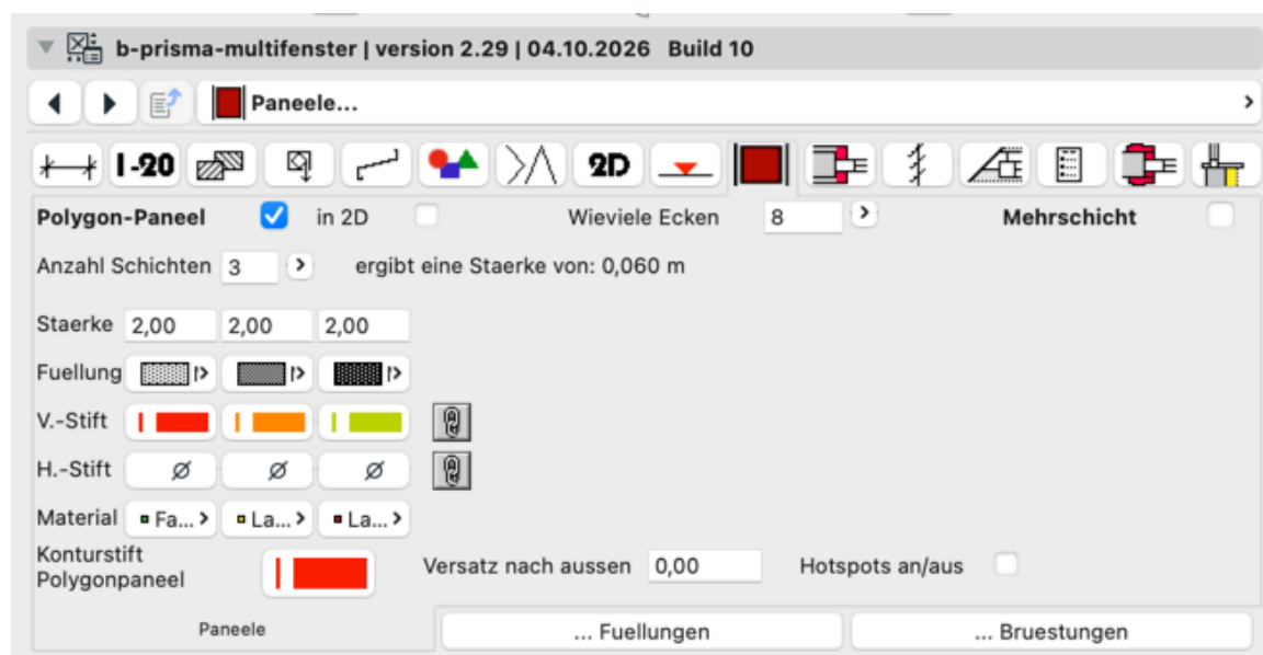
Abb. 14.1 · Dialogseite 10: Polygonpaneel mit Eckenzahl, Schichten, Stärken, Füllungen und Stiften je Schicht.
